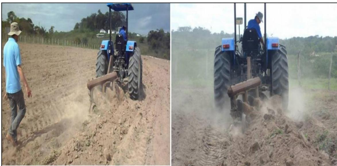
Figura 218 - - Construção de terraço de base estreita com arado de três discos.
